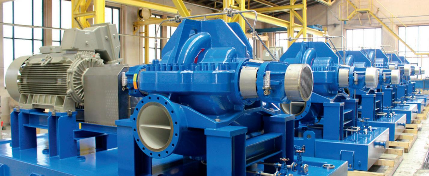
На протяжении более 100 лет фирма Аполло в г. Гёсснице успешно разрабатывает и изготавливает насосы самого широкого спектра применения, использующие различные принципы работы. Логичным продолжением такого исторического процесса стало развитие фирмой Аполло производства высококачественных тяжелых процессных насосов, специально отвечающих стандарту API 610.
